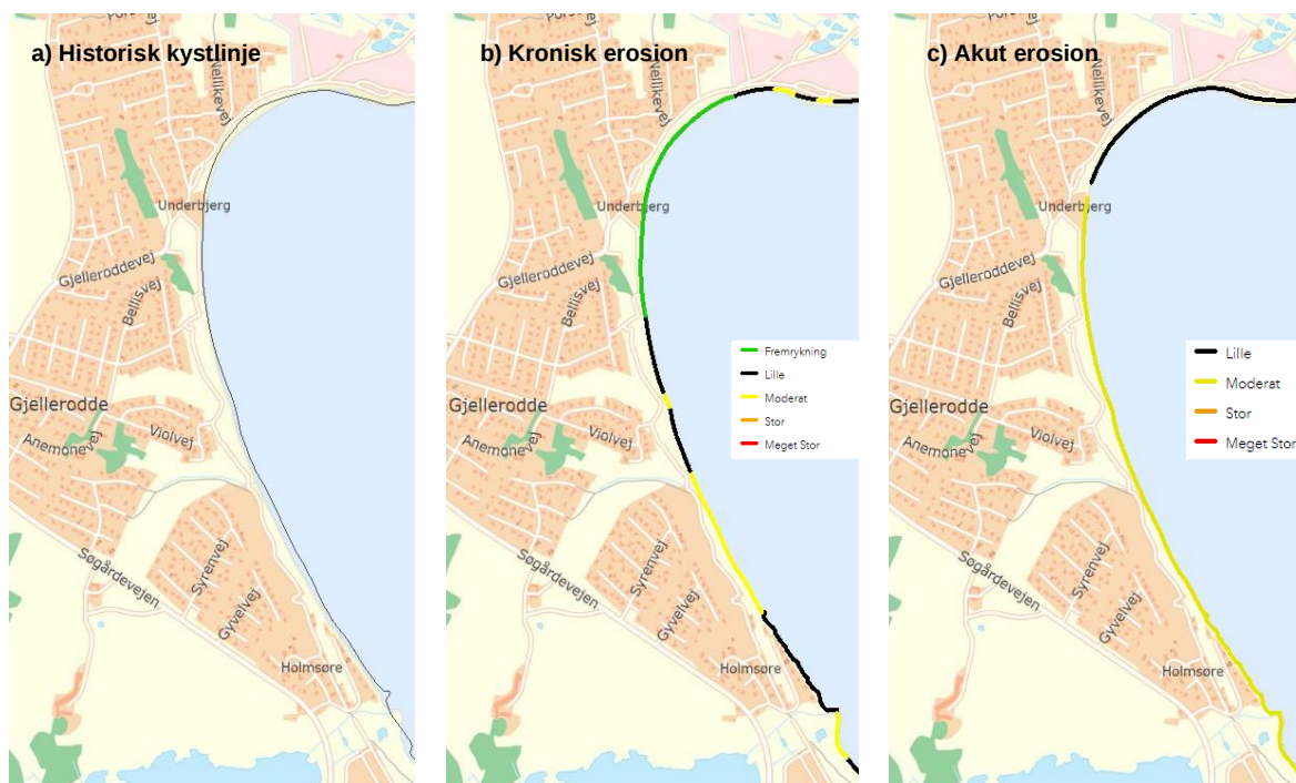
Figur 7.7.2: a) Historisk kystlinje, b) Kronisk erosion samt c) Akut erosion langs med strækningen syd for Gjeller Odde.
